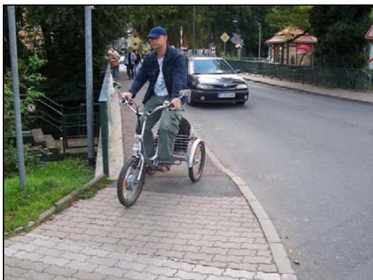
Fahrräder nutzen den abgesenkten Bord für die Gehwegauffahrt. Die begrenzte Gehwegbreite lässt aber keine Begegnung zwischen Rad/Rad bzw. Rad/Fußgänger zu. Eine Aufweitung durch Geländemodellierung im Bereich des Brückenkopfes sowie Abschrägen des Geländers würde Raum schaffen, um den Radfahrer aus Richtung Herderstraße/Goethestraße kommend (nachdem er von der Fahrbahn auf die Gehbahn aufgefahren ist) neben dem Fußgänger-verkehr konfliktarm führen zu können.
